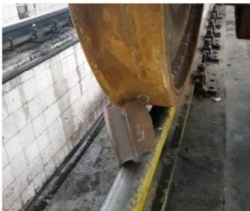
Foto 20 - Poziționarea pe care a avut-o cuponașul față de roată, când s-a produs deraierea
