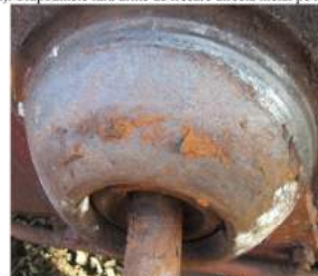
Foto12- crapodină superioară fără urme de frecare metal pe metal
