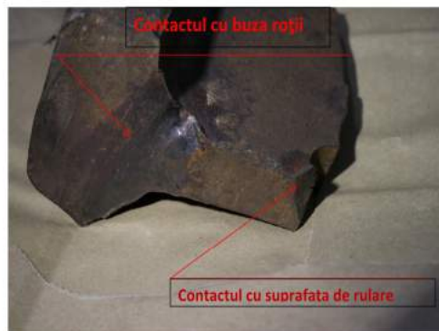
Foto 18- urma rezultată de la contactul cu buza roții cât și urma rezultată de la contactul cu suprafața de rulare a roții.
