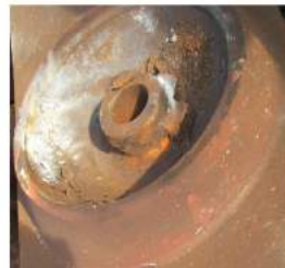
Foto13- crapodină inferioară fără urme de frecare metal pe metal
