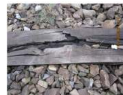
foto nr.2: Trasee necorespunzătoare de pe zona deraiată
