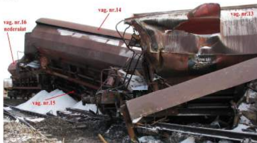
Foto 16- vagoanele 13,14,15 răsturnate și 16 nederaiat
