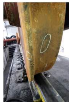
Foto 19 - urme rezultate din interacțiunea roții cu cuponșul
