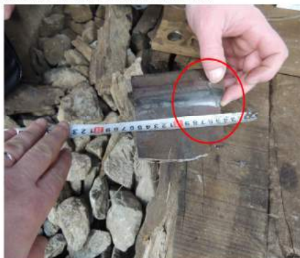
Foto 8 - așchia metalică poziționată pe cuponașul cu lungime de 110 mm
